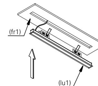
7. ao término da instalação a luminária deverá ficar como a figura acima. ligue a rede elétrica e teste o seu funcionamento.
