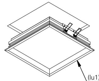
5. a luminária após instalada deverá ficar como ilustrado na imagem. ligue a rede elétrica e teste o seu funcionamento.
