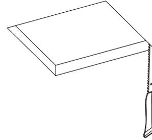
2. aloje o driver sobre o forro. faça a ligação elétrica. isole os fios separadamente com fita isolante. repita a operação envolvendo o conjunto dos fios, vedando completamente a emenda. obs: nas versões tr não utiliza driver.
