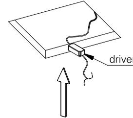
3. levante as molas de fixação (mf1) conforme a ilustração acima.
