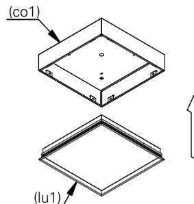
5. a luminária após instalada deverá ficar como ilustrado na imagem. ligue a rede elétrica e teste o seu funcionamento.
