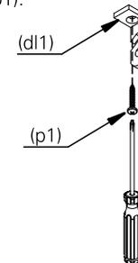
**6.** passe o cabo no deslocador (dl1) conforme ilustrado acima e ajuste a altura desejada.
