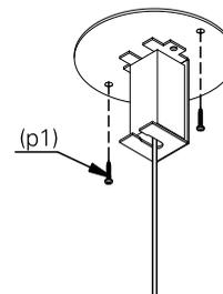
**4.** encaixe o disco de arremate (da1) e a canopla (c1) na placa de fixação (plf1). rosqueie o arremate da canopla (arc1) para o travamento.
