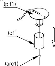
**2.** faça a ligação com a rede elétrica utilizando conectores.
