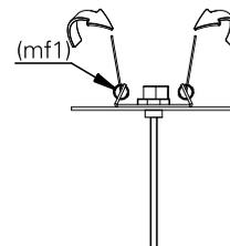
**4.** segurando as molas de fixação, encaixe a placa de fixação (plf1) no nicho.
