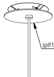
**5.** a luminária após instalada deverá ficar como ilustrado na imagem. ligue a rede elétrica e teste o seu funcionamento.
