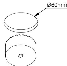
**2.** aloje o driver sobre o forro. faça a ligação elétrica. isole os fios separadamente com fita isolante. repita a operação envolvendo o conjunto dos fios, vedando completamente a emenda.
