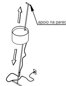
**6.** para fixar a luminária no local, fixe a braçadeira (br1) na parede e em seguida, encaixe a haste superior (hs1).
