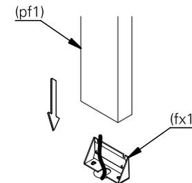
6. termine a fixação encaixando o perfil (pf1) no fixador (fx1). em seguidarosqueie e aperte os parafusos (p3).
