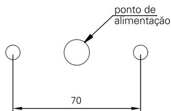
3. utilize as buchas (b1) e os parafusos (p1) para fixar o fixador (fx1) no piso.
