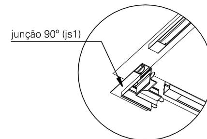
6. para linha rocket, ao instalar ou reposicionar, destrave o conector. após instalada trave-a e faça o giro e orientação conforme a necessidade.
