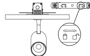
7. o perfil após instalado aplique a luminária e que deverá ficar como ilustrado na imagem. ligue a rede elétrica e teste o seu funcionamento.
