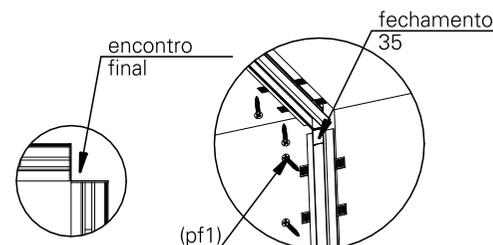
5. encaixe a junção 90° para encontros 90°, encaixe o fechamento 90° na junção.
