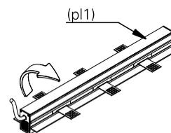
4. parafuse o perfil no gesso e faça o acabamento. encaixe o fechamento 35 na saída de cabo do driver
