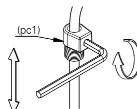
5. encaixe novamente o prensa cabo (pc1) no suporte de fixação (sf1). certifique-se de que o parafuso esteja bem apertado.
