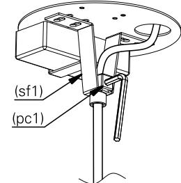
6. faça a ligação elétrica. isole os três fios separadamente com fita isolante. repita a operação envolvendo o conjunto dos três fios, vedando completamente a emenda.
