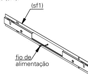
**2.** utilize os parafusos (p1) para fixar os suportes de fixação (sf1) na parede.
