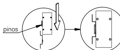
**5.** a luminária após instalada deverá ficar como ilustrado na imagem. ligue a rede elétrica e teste o seu funcionamento.
