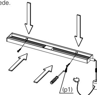
**3.2.** ajuste o fio até que o peso (ps1) encoste no chão, mantendo o cabo esticado.
