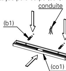
**2.1.** faça a ligação do cabo de energia não esquecendo o fio terra.
