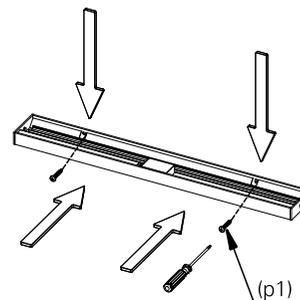
**4.1.** a luminária após instalada deverá ficar como ilustrado na imagem. ligue a rede elétrica e teste o seu funcionamento.
