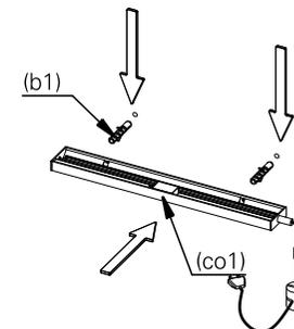
**2.2.** utilize o parafuso (p1) para fixar o corpo (co1) na parede.
