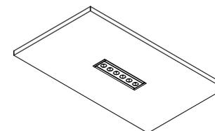
**2.** aloje o driver sobre o forro. faça a ligação elétrica. isole os fios separadamente com fita isolante. repita a operação envolvendo o conjunto dos fios, vedando completamente a emenda.
