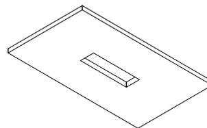
**5.** a luminária após instalada deverá ficar como ilustrado na imagem. ligue a rede elétrica e teste o seu funcionamento.
