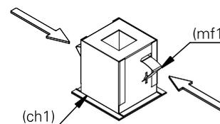
**4.** encaixe o chassi (ch1) no nicho. por dentro do chassi (ch1), pressione as molas de fixação (mf1) para fora de modo a travar a luminária.
