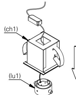
**3.** pressione as molas de fixação (mf1) para dentro do chassi (ch1).
