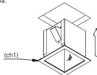
**5.** aloje o driver sobre o forro. faça a ligação elétrica. isole os fios separadamente com fita isolante. repita a operação envolvendo o conjunto dos fios, vedando completamente a emenda.
