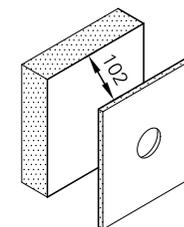
**2.3.** faça a ligação elétrica. isole os fios separadamente com fita isolante. repita a operação envolvendo o conjunto dos fios, vedando completamente a emenda. após encaixe a luminária no nicho. certifique-se que a tensão da luminária é compatível com a rede.
