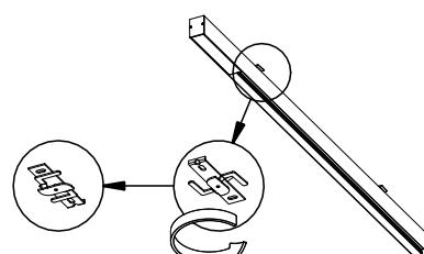
5. a luminária após instalada deverá ficar como ilustrado na imagem. ligue na rede elétrica e teste o seu funcionamento.
