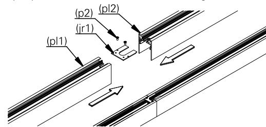
a2. para instalação em 90° dos perfis, encaixe o perfil (pl1) na junção 90° (j91) até a metade e em seguida encaixe o perfil (pl2). aperte os parafusos (p2) para o travamento conforme a imagem abaixo.
