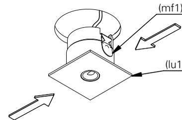
4. posicione a luminária (lu1) de forma que o feixe de luz (fl1) esteja sentido a parede (pd1), conforme a imagem:
