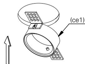
2.2 utilize os parafusos (p1) para fixar a luminária (lu1) e de o acabamento no forro com gesso, não deixando o parafuso aparente. espere a secagem do gesso para prosseguir a próxima etapa.
