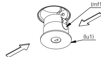
5.2 a luminária após instalada deverá ficar como ilustrado na imagem. ligue a rede elétrica e teste o seu funcionamento.
