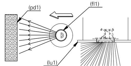
3.2 utilize os parafusos (p1) para fixar a luminária (lu1) e de o acabamento no forro com gesso, não deixando o parafuso aparente. espere a secagem do gesso para prosseguir a próxima etapa.
