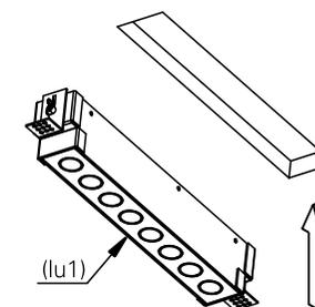
7. utilize os parafusos (p1) para fixar o corpo (co1) e de o acabamento no forro com gesso, não deixando o parafuso aparente.
