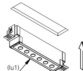
5. utilize os parafusos (p1) para fixar o corpo (co1) e de o acabamento no forro com gesso, não deixando o parafuso aparente. espere a secagem do gesso para prosseguir a próxima etapa.
