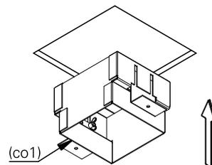
4. nivele o corpo (co1) com o forro e aperte as porcas borboletas (pb1) do suporte de fixação (sf1).
