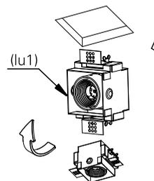
**5.** utilize os parafusos (p1) para fixar o corpo (co1) e de o acabamento no forro com gesso, não deixando o parafuso aparente. espere a secagem do gesso para prosseguir a próxima etapa.
