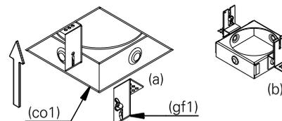
5. utilize os parafusos (p1) para fixar o chassi (ch1) e de o acabamento no forro com gesso, não deixando o parafuso aparente. espere a secagem do gesso para prosseguir a próxima etapa.
