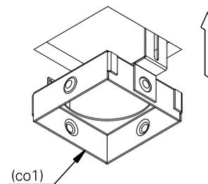
4. passe as grapas de fixação (gf1) pelo centro do corpo (co1) conforme a imagem (a) e encaixe na fresta conforme a imagem (b) faceando o corpo com o gesso.
