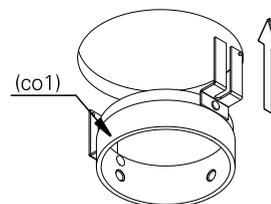
4. passe as grapas de fixação (gf1) pelo centro do corpo (co1) conforme a imagem (a) e encaixe na fresta conforme a imagem (b) faceando o corpo com o gesso.
