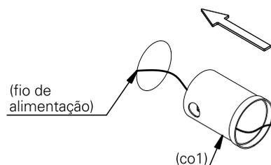
**5.** faça a ligação elétrica. isole os fios separadamente com fita isolante. repita a operação envolvendo o conjunto dos fios, vedando completamente a emenda.
