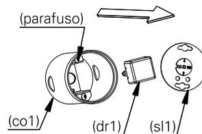
**4.** passe o fio de alimentação pelo orifício do corpo (co1) e em seguida encaixe-o no furo.
