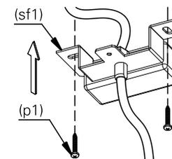
**2.2.** faça a ligação elétrica. isole os fios separadamente com fita isolante. repita a operação envolvendo o conjunto dos fios, vedando completamente a emenda.
