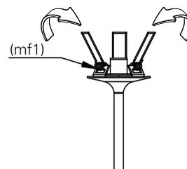
**3.1.** segurando as molas de fixação, encaixe a flange de fixação (ff1) no nicho.
