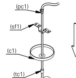
2. utilize o parafuso (p1) para fixar o suporte de fixação (sf1) na caixa de alimentação ou no forro.
