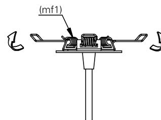
4. segurando as molas de fixação, encaixe a moldura (m1) no nicho.
