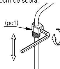
**4.** encaixe o prensa cabo (pc1) no suporte de fixação (sf1).
