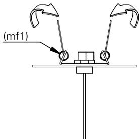
**5.** segurando as molas de fixação, encaixe a placa de fixação (plf1) no nicho.
