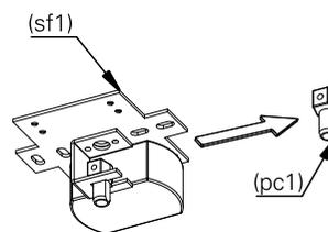
**3.** utilize os parafusos (p1) para fixar o suporte de fixação (sf1) na caixa de alimentação ou no forro.
