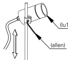
4. para orientar o fecho de luz, afrouxe o parafuso da haste com a chave allen e mova a luminária (lu1) para o ângulo desejado. após ajustado, aperte o parafuso com a chave allen.
