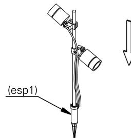
2. faça a ligação elétrica. isole os fios separadamente com fita isolante. repita a operação envolvendo o conjunto dos fios, vedando completamente a emenda.
