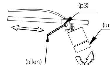
6. para orientar o fecho de luz, afrouxe o parafuso (p4) da haste com a chave allen e mova a luminária (lu1) para o ângulo desejado. após ajustado, aperte o parafuso com a chave allen.
