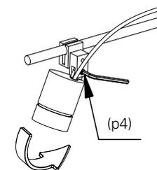
7. faça a ligação elétrica. isole os fios separadamente com fita isolante. repita a operação envolvendo o conjunto dos fios, vedando completamente a emenda.
