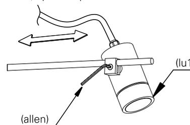
4. para orientar o fecho de luz, afrouxe o parafuso da haste com a chave allen e mova a luminária (lu1) para o ângulo desejado. após ajustado, aperte o parafuso com a chave allen.
