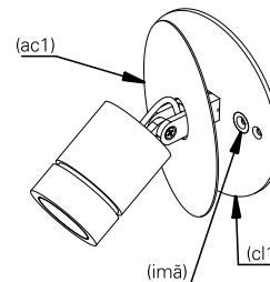
5. faça a ligação elétrica. isole os fios separadamente com fita isolante. repita a operação envolvendo o conjunto dos fios, vedando completamente a emenda.
