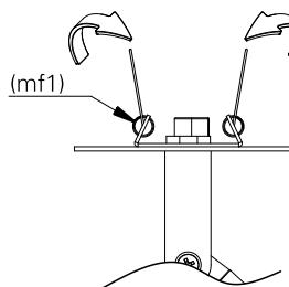
4. segurando as molas de fixação, encaixe a placa de fixação (plf1) no nicho.
