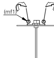
**4.1** segurando as molas de fixação, encaixe a placa de fixação (plf1) no nicho.
