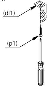
**6.2** passe o cabo no deslocador (dl1) conforme ilustrado abaixo e ajuste a altura desejada.
