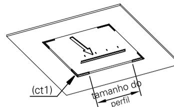
**5.** encaixe na diagonal a manta (mt1) conforme etapas mostrada na imagem acima. em seguida faça o encaixe as laterais da manta.
