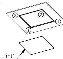
**6.** com o soprador, aqueça a manta até estar suficientemente esticada.
