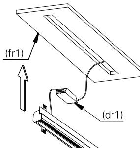
7. utilize os parafusos (p1) para fixar o perfil (pf1) e dê o acabamento no forro com gesso, não deixando o parafuso aparente.
