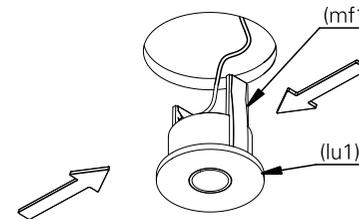
4. a luminária após instalada deverá ficar como ilustrado na imagem. ligue a rede elétrica e teste o seu funcionamento.
