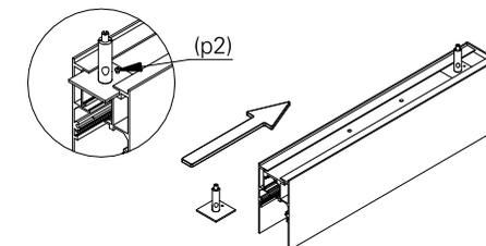
**6.** em caso de emenda de perfil, encaixe a junção do trilho (jt1) e a junção reta (cr1) no perfil (pl1). empurre a junção do trilho para dentro da ranhura conforme a figura acima.
