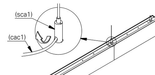
**8.** ao término da instalação a luminária deverá ficar como a figura acima. ligue a rede elétrica e teste o seu funcionamento.
