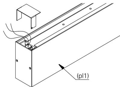
**2.** utilize o parafuso (p1) para fixar o p-fit (prf1) e o c-fit (cf1) no forro conforme a imagem acima. caso for utilizar a canopla, pule as etapas 2 e 3. instale o processo da etapa 4 nas duas pontas da luminária.
