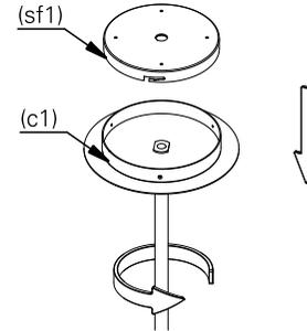
2. passe os fios de alimentação pelo orifício do suporte de fixação (sf1). utilize o parafuso (p1) para fixar o suporte de fixação na laje.
