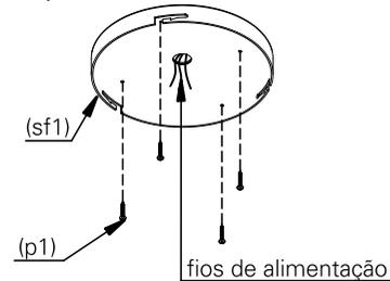
3. faça a ligação elétrica. isole os fios separadamente com fita isolante. repita a operação envolvendo o conjunto dos fios, vedando completamente a emenda.
