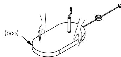
**2.** coloque o anel de acabamento (aa), com cuidado faça a ligação elétrica (a1) dos conectores, encaixe a haste principal (hp) na base de concreto (bco) conforme a imagem (a1).
