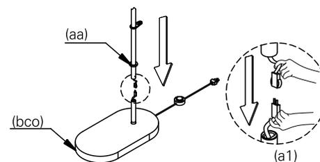
**3.** aperte os dois parafusos para travar a haste principal (hp) conforme imagem a2, desça o anel de acabamento até a base de concreto.
