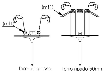
**4.1.** segurando as molas de fixação, encaixe a placa de fixação (plf1) no nicho.
