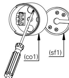
**5.** com o parafuso (p1), fixe o suporte de fixação (sf1) no local desejado.
