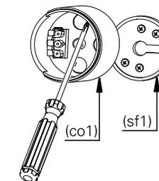
**7.** encaixe o trava perfil (tp1) no corpo (co1). em seguida, rosqueie novamente a tampa (tm1) no corpo (co1).
