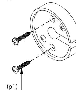
**6.** encaixe o corpo (co1) no suporte de fixação (sf1) e aperte o parafuso no interior do corpo.
