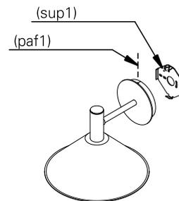
2. passe os fios de alimentação pelo orifício do suporte (sup1). utilize os parafusos (paf2) para fixá-lo na caixa ou ponto de passagem.
