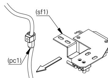
**3.** utilize o parafuso (p1) para fixar o suporte de fixação (sf1) na caixa de alimentação ou no forro.
