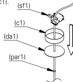
**2.** desencaixe o prensa cabo (pc1) do suporte de fixação (sf1).
