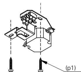
**4.** utilizando a chave allen, solte o cabo do prensa cabo (pc1) e ajuste a altura da luminária. prenda o cabo com a chave allen e corte o excedente, deixando 10cm de sobra.
