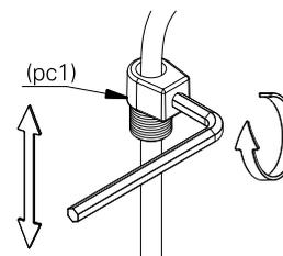
**5.** encaixe novamente o prensa cabo (pc1) no suporte de fixação (sf1). certifique-se de que o parafuso esteja bem apertado.
