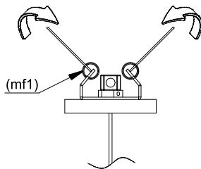
**4.** segurando as molas de fixação (mf1), encaixe a
