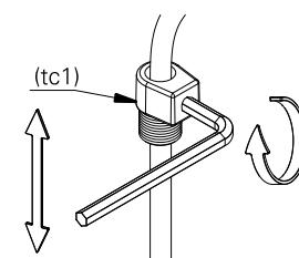
5. encaixe novamente o trava cabo (tc1) no suporte de fixação (sf1). certifique-se de que o parafuso esteja bem apertado.
