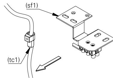
3. utilize o parafuso (p1) para fixar o suporte de fixação (sf1) na caixa de alimentação ou no forro.
