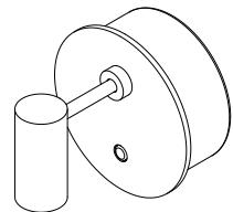
2. fixar o suporte de fixação (sf1) na parede.
