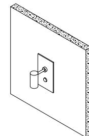
3. fixe o suporte interno (si1) na caixa 4x2 (cx1) utilizando os parafusos (p1).
