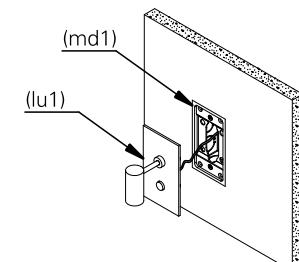
2. faça a ligação elétrica. isole os fios separadamente com fita isolante. repita a operação envolvendo o conjunto dos fios, vedando completamente a emenda.
