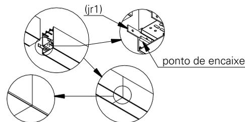
**4.** encaixe o chassi (ch1) e em seguida encaixe o difusor (df1) no perfil (pf1).
