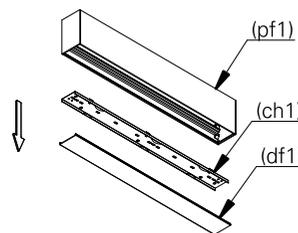
**2.** faça um furo no teto e encaixe a bucha (b1). utilize o parafuso (p1) para fixar o perfil (pf1) no teto. repita a operação para a outra ponta da luminária mantendo o alinhamento desejado.
