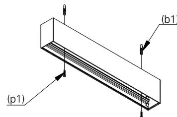
**3.** escolha o lado onde o fio de alimentação irá passar e faça a ligação elétrica. isole os fios separadamente com fita isolante. repita a operação envolvendo o conjunto dos fios, vedando completamente a emenda.
