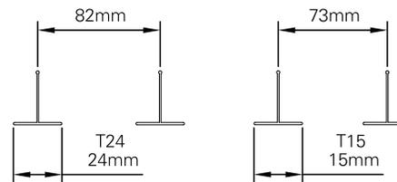
**5.** ao término da instalação a luminária deverá ficar como a figura abaixo. ligue a rede elétrica e teste o seu funcionamento.
