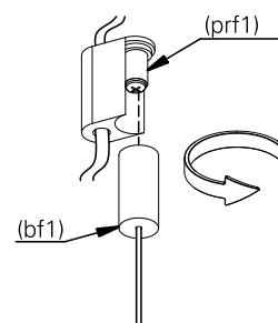
4. nas conexões sem alimentação, utilize o parafuso (p1) para fixar o p-fit (prf1) no forro e em seguida rosqueie o b-fit (bf1).
