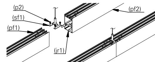
8. para instalação linear dos perfis com duas fita led, encaixe o perfil (pf1) no suporte de fixação (sf2) e na junção reta (jr1) até a metade e em seguida encaixe o perfil (pf2). aperte os parafusos (p2) para o travamento conforme a imagem acima.
