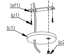
6. a luminária após instalada deverá ficar como ilustrado na imagem. ligue na rede elétrica e teste o seu funcionamento.
